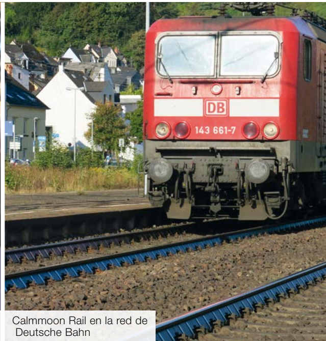
Detalle de la protección contra el ruido del alma del carril Calmmoon Rail
