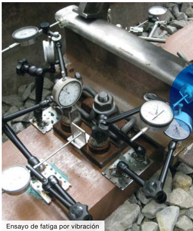
Ensayo de fatiga bajo el apoyo del carril
